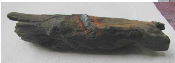
Abb. 3: Fremdkörper (Ast) entfernt
