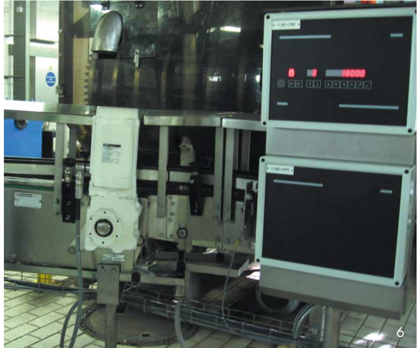
Abb. 6: Danfoss Bauer Aseptic Motor am Transporteur der Füllmaschine
