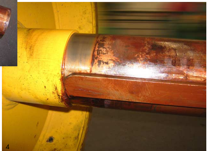
Abb. 3 und 4: Aufarbeitung der Trommelsteckwellen
