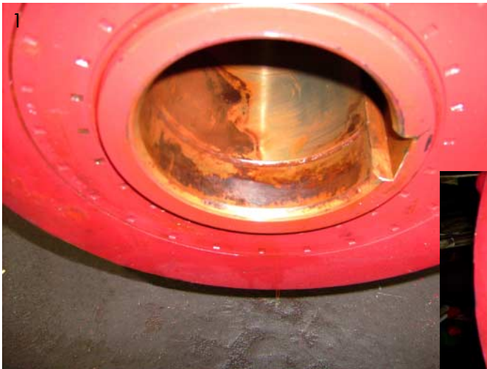
Abb. 1 und 2: Erneuerung der Getriebearbeitshohlwelle
