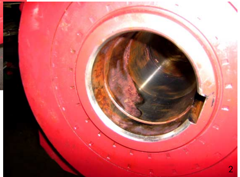
Abb. 1 und 2: Erneuerung der Getriebearbeitshohlwelle
