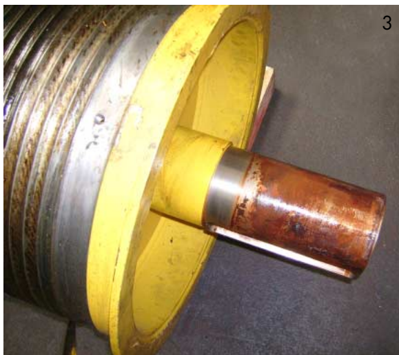
Abb. 3 und 4: Aufarbeitung der Trommelsteckwellen
